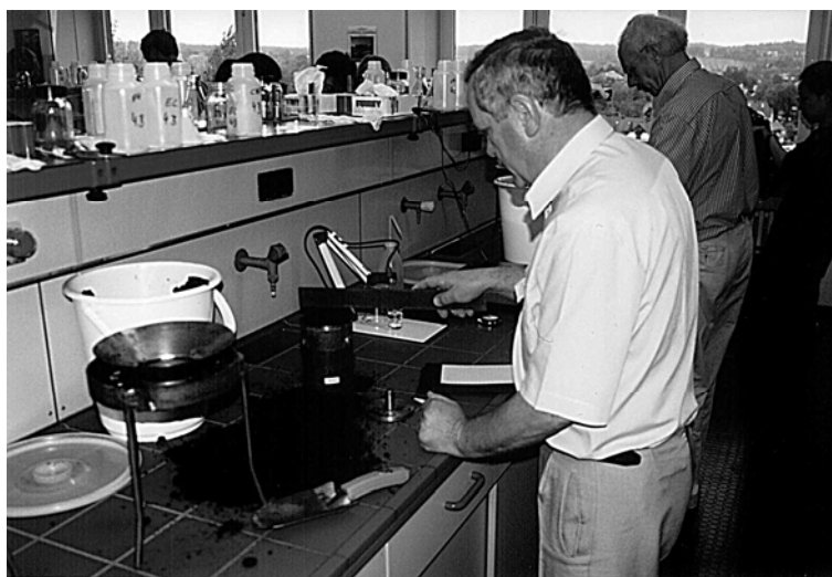
Fot. 2. Oznaczanie gęstości laboratoryjnej podłoża podczas międzynarodowych ćwiczeń Phot. 2. Determination of laboratory bulk density of substrate during the international workshop
